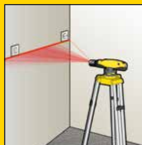
◀ Nivelación y alineación horizontal y vertical
